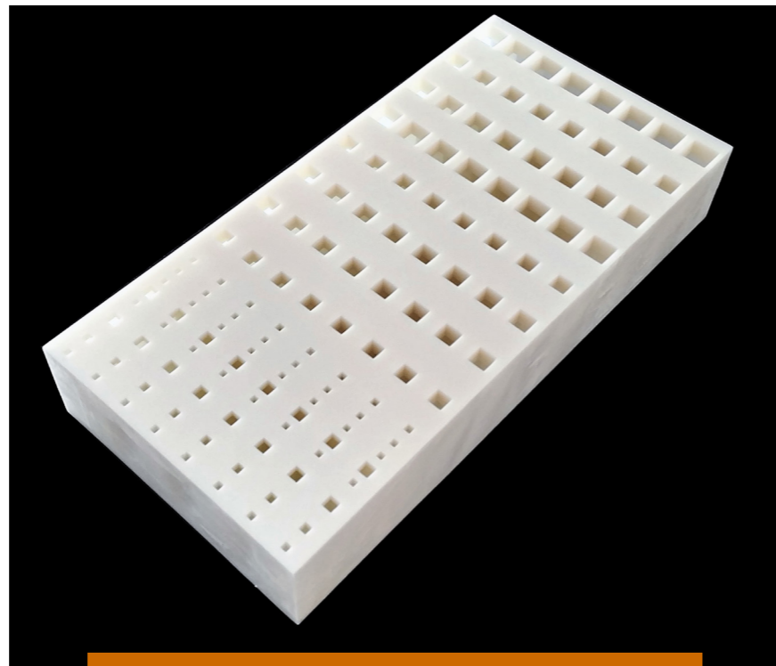
Technologie pour l'absorption du bruit se plaçant sous forme de paroi d'un conduit et développée au Laboratoire d'Acoustique de l'Université du Mans (LAUM, UMR CNRS 6613).
